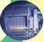
溶解炉の中でアルミ缶が 溶かされます。
